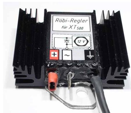
Die von mir entwickelte Elektronik steigert die Leistungs-Effizienz der Lichtmaschine durch Verdopplung der Spannung, wobei **Lichtmaschine und Kabelbaum unverändert bleiben**. Da der Strom nach wie vor der gleiche ist, wird die Lichtmaschine der XT nicht stärker belastet. Zusätzlich wird – im Gegensatz zum Original-Regler – der Ladezustand des Akkus (Batterie) exakt gemessen und der Ladestrom bei voll geladenem Akku heruntergeregelt. Die Lebensdauer des Akkus erhöht sich dadurch erheblich.
