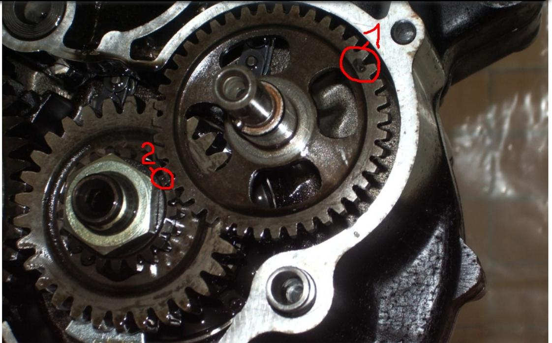
Du musst die Kurbelwelle drehen, bis beide Ventile geschlossen sind, und dann die Welle mit fluchtenden Markierungen einsetzen. Das geht so:
